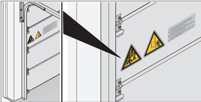
Abb. 1.2 Aufkleber am Torblatt anbringen
