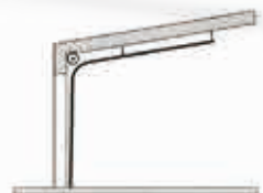
Normalbeschlag mit Dachfolge Sturzbedarf 290mm, Seitenanschlag 90mm (Alu 100mm) Normal installation with roof contour Lintel requirement 290mm, side inset 90mm (Alu 100mm)
