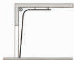
Höherführung Sturzbedarf 510mm, Seitenanschlag 90mm (Alu 100mm) Higher guide Lintel requirement 510mm, side inset 90mm (Alu 100mm)
