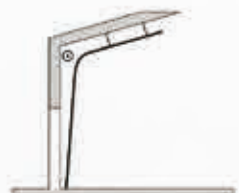
Höherführung mit Dachfolge Sturzbedarf 560mm, Seitenanschlag 90mm (Alu 100mm) Higher guide with roof contour Lintel requirement 560mm, side inset 90mm (Alu 100mm)
